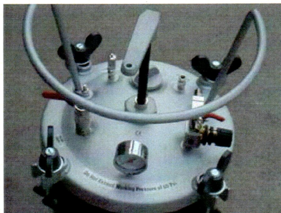
Fig-4 Couverture de la cuve d'injection
