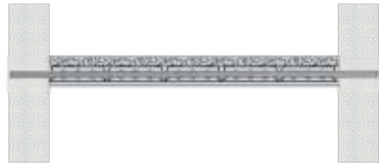
Renforcement dalle existante
